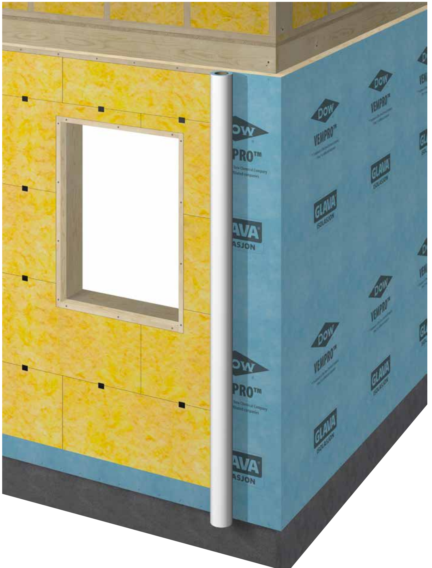
Vindsperreduk rulles ut
