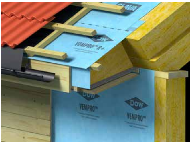
Fig. 14 Prinsipp ved utstikkende sperrer
