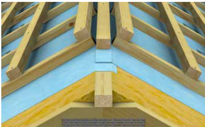
Fig. 17 Prinsipp for avslutning i mønet
