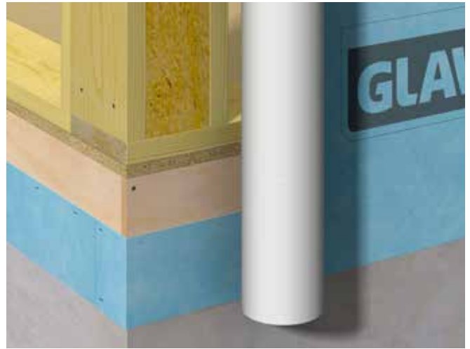
Fig. 28 Innfestet svillemembran før montering av vindsperre
