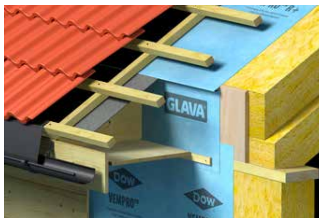
Fig. 15 Prinsipp for løse takutstikk
