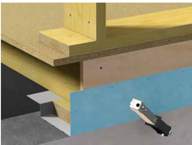
Fig. 24 Svillemembran med to lepper
