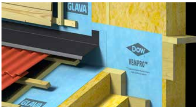
Fig. 18 Avslutning mot oppbygg
